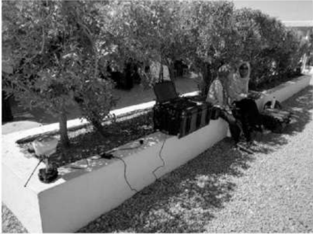
الشكل 2: المحطة الأرضية ومحطة GNSS RTK الأساسية (15 ° 28' 09.1574" خط العرض شمالاً ، 32 ° 32' 51.7217" بوصة لون E ، الارتفاع - القطع الناقص 393.180 م - ارتفاع القاعدة: 0.095 م).
