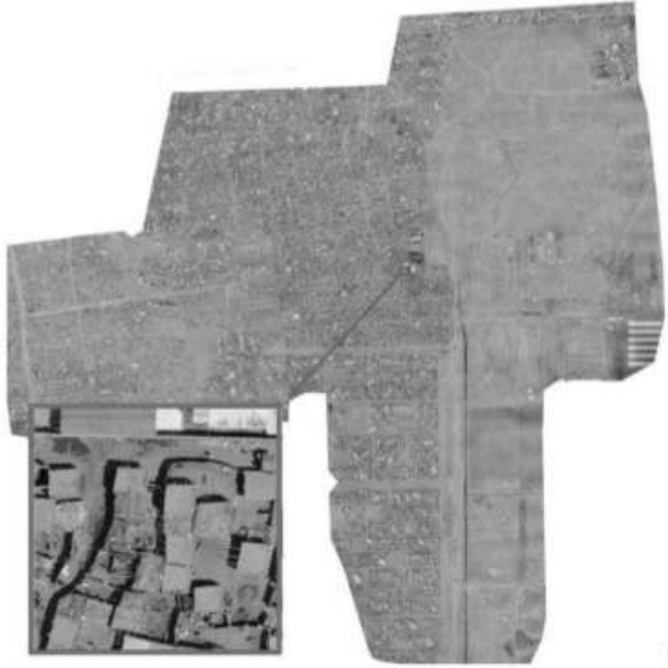
الشكل 6: فسيفساء (اللون الحقيقي) لمنطقة مايو وأنغولا مستمدة من مسح الطائرات بدون طيار (القرار 3.5 سم / بكسل)
